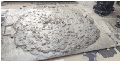
Gambar 4.1 hasil uji slump dengan alas 60 cm
