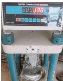
Gambar 4.4 uji tekan beton berdasarkan persentase fly ash
