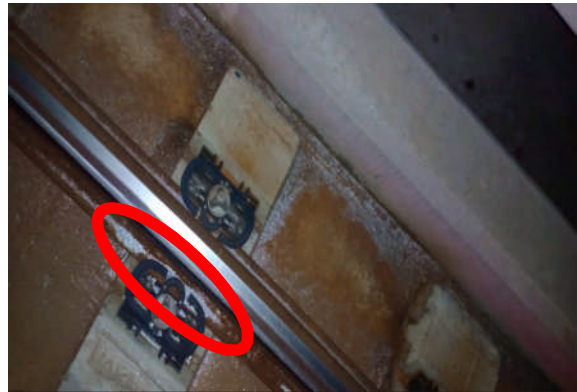
Gambar IV. 2 Gram besi roda dan rel yang aus
